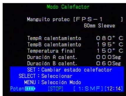
Figura 45. Pantalla del Modo Calentador
