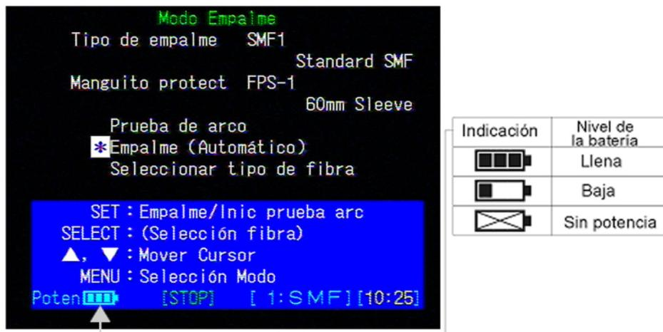
Figura 7. Indicador de nivel de la batería
