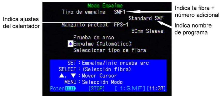
Figura 31. Pantalla del menú del Modo Empalme
