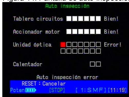
Figura 15. Detección de error en auto-inspección
