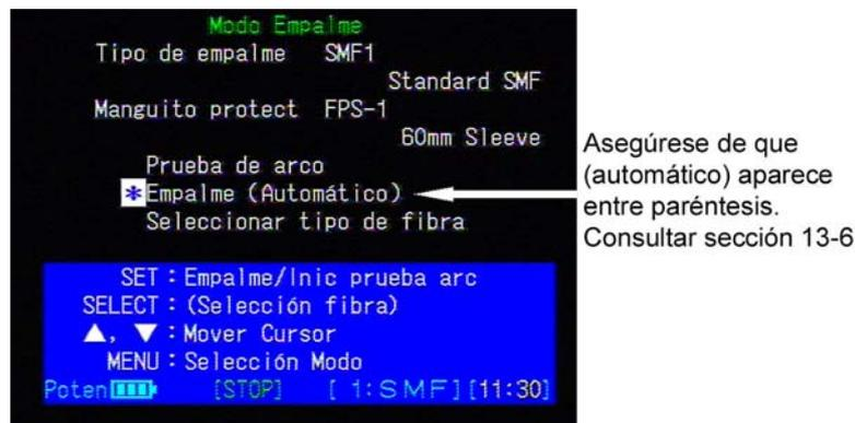
Figura 24. Inicio del empalme automático
