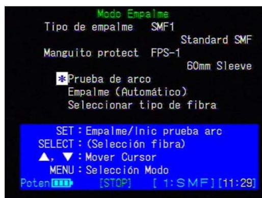
Figura 21. Inicio de una Prueba de Arco
